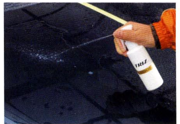
▲ボンネット片面につき2〜3回程度トリガーを引いて液剤を噴霧
